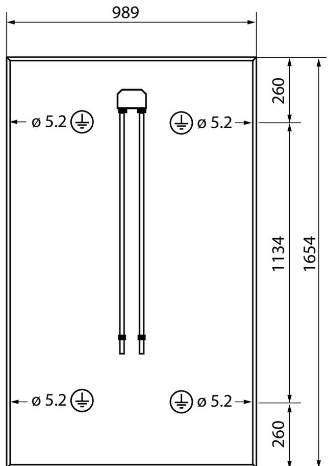
Abbildung 2: Bemaßte Modulschizze
